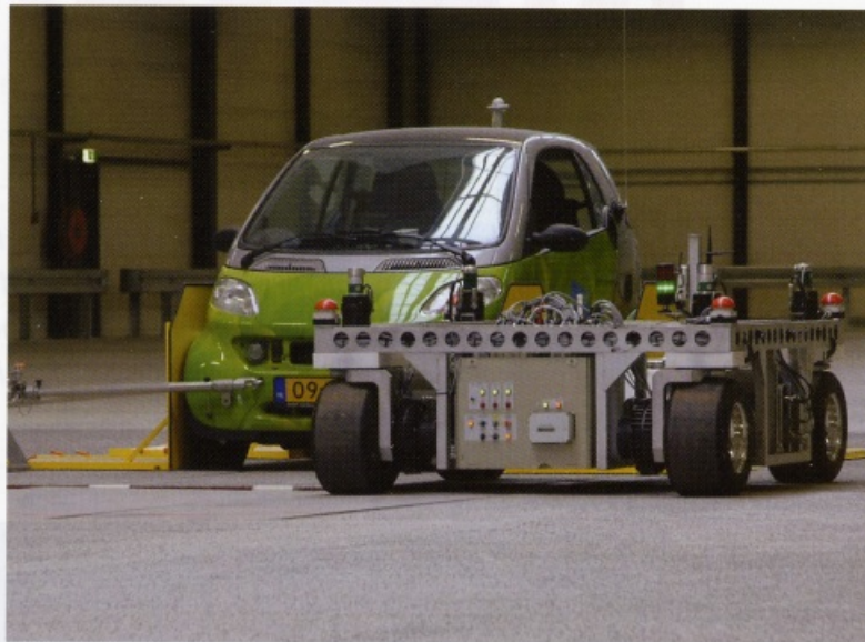
Met een intelligent voertuig op de rollenbank, omringd door 'moving bases', kunnen realistische verkeerssituaties worden nagebootst.
