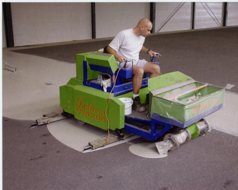
De coatingmachine heeft een capaciteit van maar liefst 4000 m 2 per dag.
